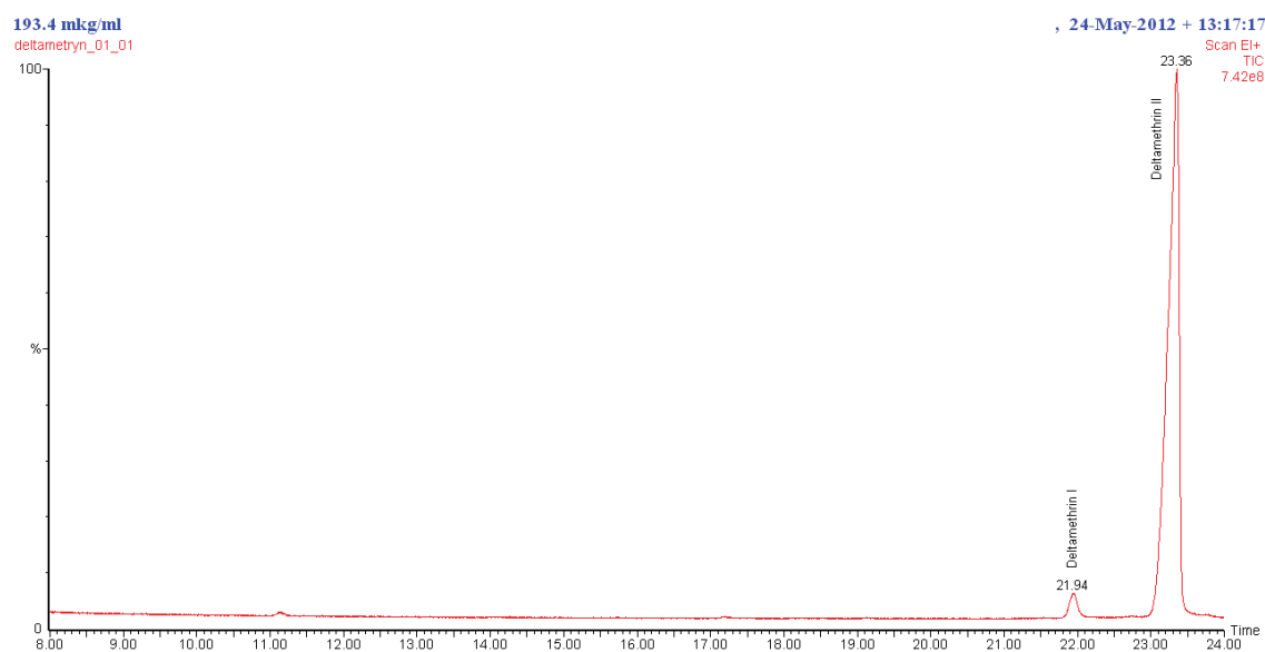
Рис. 1. Хроматограмма стандартного раствора дельтаметрина в ацетоне (хромато-масс-спектрометр „CLARUS 600 T” фирмы „Perkin Elmer”, капиллярная колонка «Elite-5MS»)
