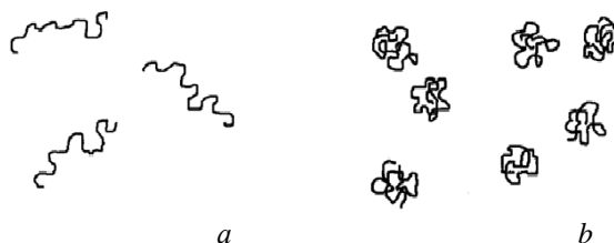
Рис. 4. Конформація макромолекул ПГМГ: а – розгорнута - в розведеному розчині; б – згорнута - в концентрованому розчині.
