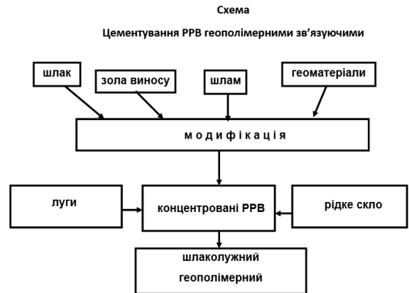
Рис. 1 Схема цементування РРВ.
