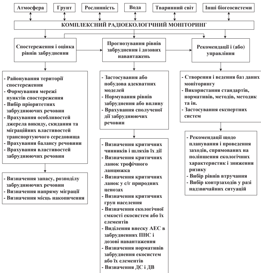
Рис. 2. Схема комплексного радіоекологічного моніторингу навколишнього природного середовища у районі розташування АЕС
