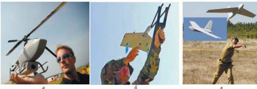
Рис. 1. БПЛА класу «мікро» ( \mu ): а– схема «вертоліт»; б, в– схема «літак» [4]
