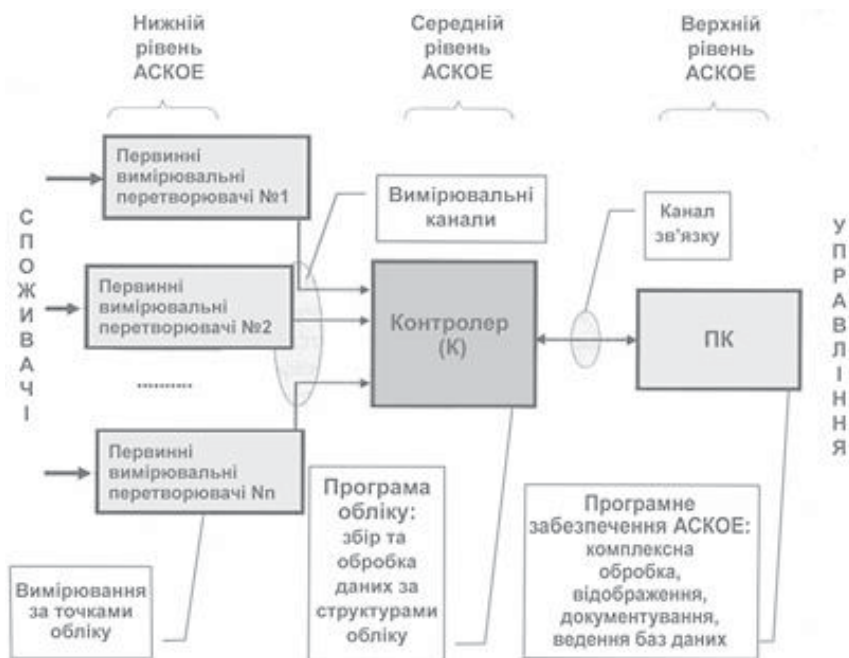
Рис. 1. Узагальнена структурна схема типової сучасної АСКОЕ
