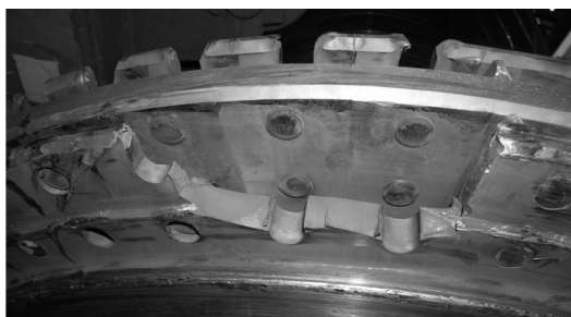
Рис. 1. Загальний вигляд одного з фрагментів пошкодженого диска ротора парової турбіни.
