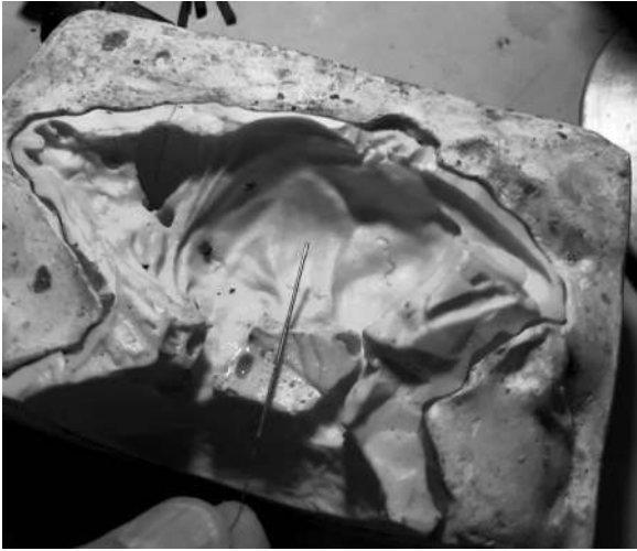
Рис. 4. Розміщення трубки голчастої \varnothing 0,8 мм в прес-формі
