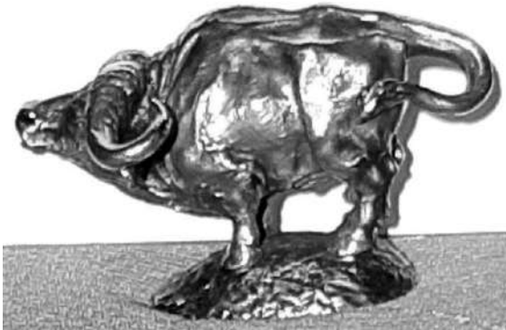
Рис. 6. «Буйвол» без утяжини і усадочних дефектів на поверхні, залитий із застосуванням нової технології
