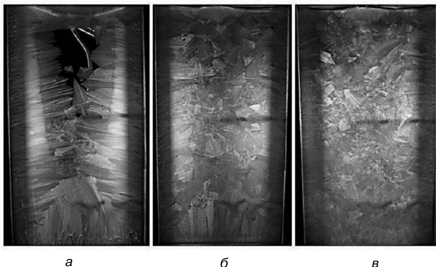
Рис. 4. Структура злитків, одержаних при різній інтенсивності процесів тепловідведення від сплаву: а – висока; б – середня; в – низька
