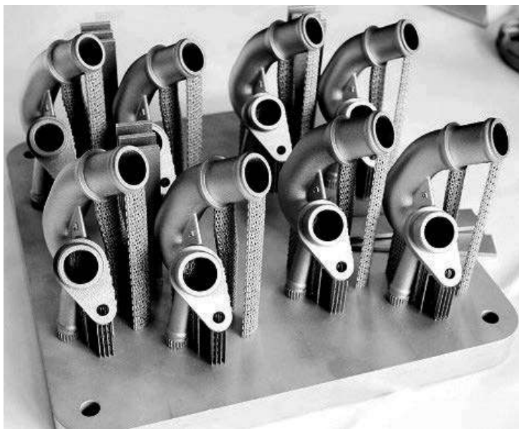
Рис. 1. Металеві 3D-друковані патрубки-роз'єми для двигуна Audi W12 [1]
