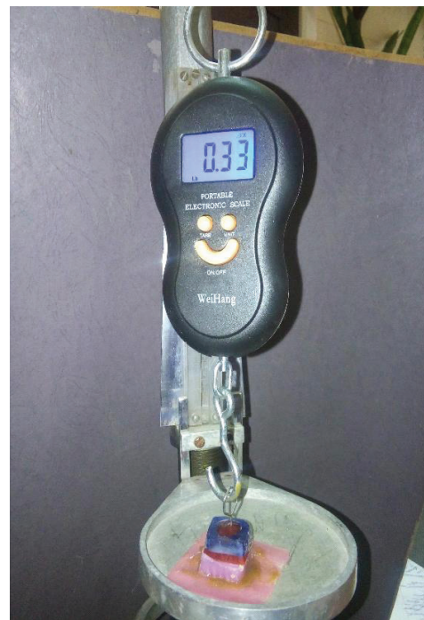
Рис. 2. Процес випробування зразків на адгезію
